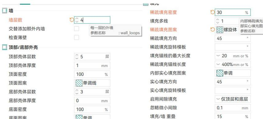
如图所示，根据强度要求，墙层数可提高到 4-6 层，稀疏填充密度提高至 30-40%，稀疏填充图案可调整为螺旋体甚至蜂窝型。（具体各种参数的影响可参考提高强度）
