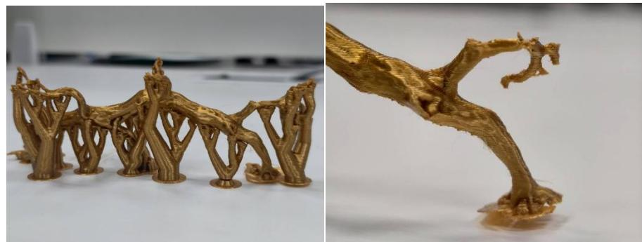
这种情况下可适当增加支撑选项中的支撑 Z 距离（如 0.2mm 增加至 0.24mm、0.28mm 等）以及降低支撑的分支密度（如 30%降低至 15-20%），可使支撑和模型之间的粘连性降低，从而降低拆除支撑时损坏模型主体的几率。
